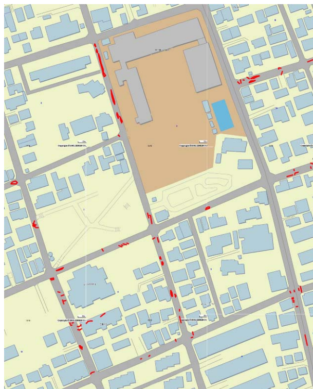
図 4 谷埋め盛土部の経年変化により生じたアスファルトの亀裂分布 (2006 年調査)
