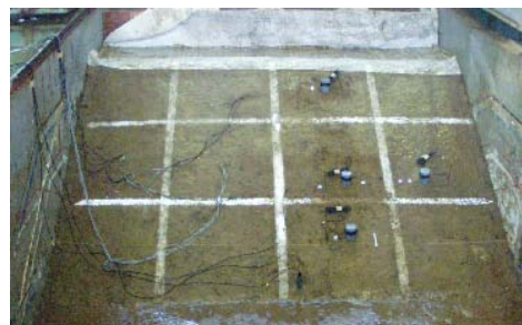
図一 2 a 大型模型実験の法面崩壊が開始直前の様子 2)
