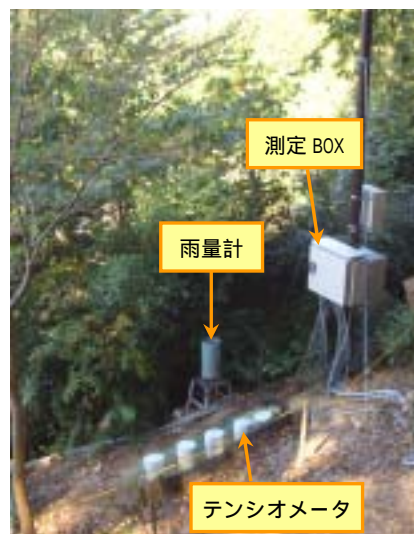
写真-1 M地点の計測システム
