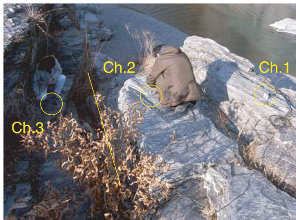
図-1 常時微動の観測状況。(a) Site A (不安定と考えられる岩塊), (b) Site B (安定と考えられる岩塊)
