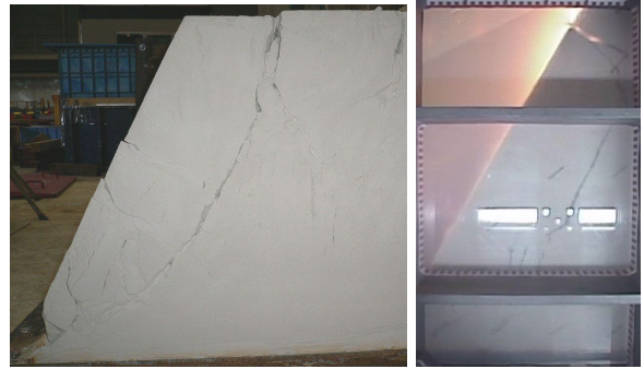
図-3 石膏材料模型の崩壊状況(左:不連続面なし-実験後,右:流れ盤-加振中)
