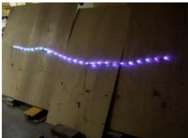
(a) 変位が生じ始め相対変位が生じた部分の色が変化し始める様子
