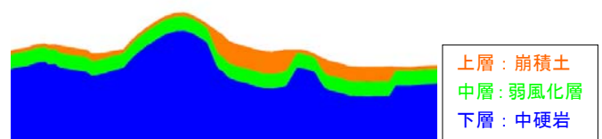
図-1 地質断面 (地表付近を拡大)
