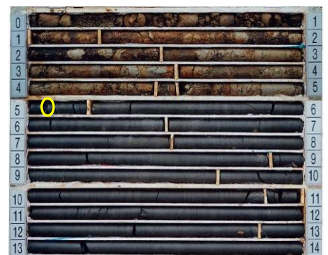
図-3 試験実施孔のコア （丸囲み：地すべり面）
