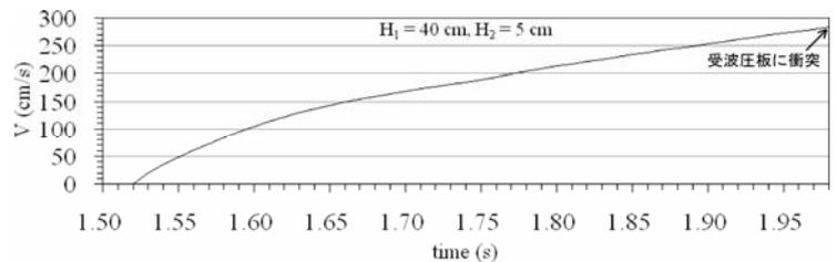
**図 6** 漂流物の移動速度
