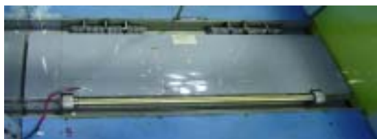
写真1 水路床に設置した模型フラップ
