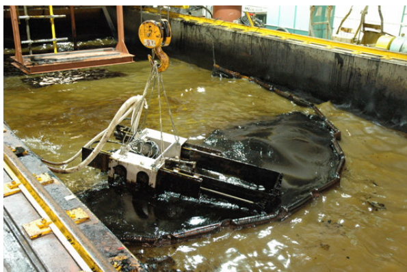
写真-2 かき寄せバケット式スキマーの水槽実験 (3) 実験の結果と考察
