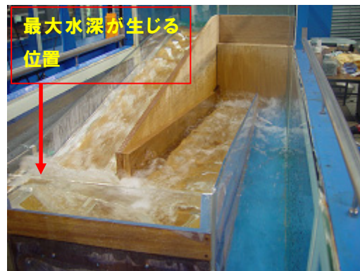
写真 2 s/h_c = 0.357 の流況( h_c = 70\text{cm} の場合)
