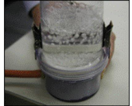
図-1 通気・防水シートを通る空気の様子
