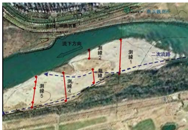
写真-1 地形測量に用いた測線と予測 2 次流路.
