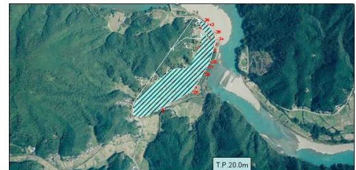
図5 地盤高測量によって作製した浸水マップ(手洗川地区 T.P.20.0mの場合)
