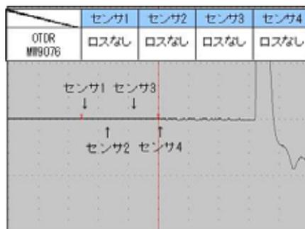
図-3 OTDR 測定結果 (初期状態)
