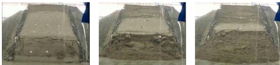
写真-3 土砂崩壊の様子(左から1秒、3秒、5秒後)
