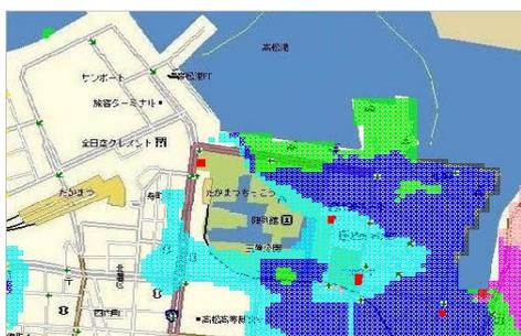
図 4.1 防波堤設置後のシミュレーション結果
