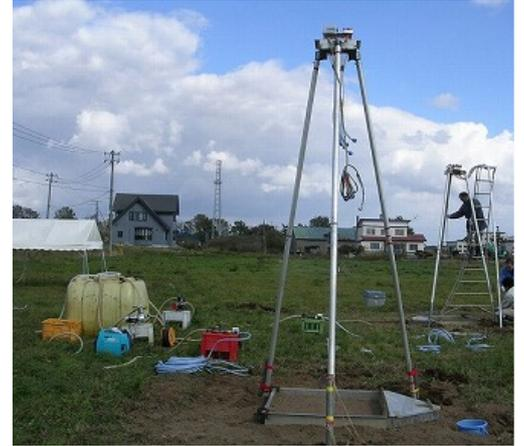
写真-1 散水試験装置（風よけ無し）
