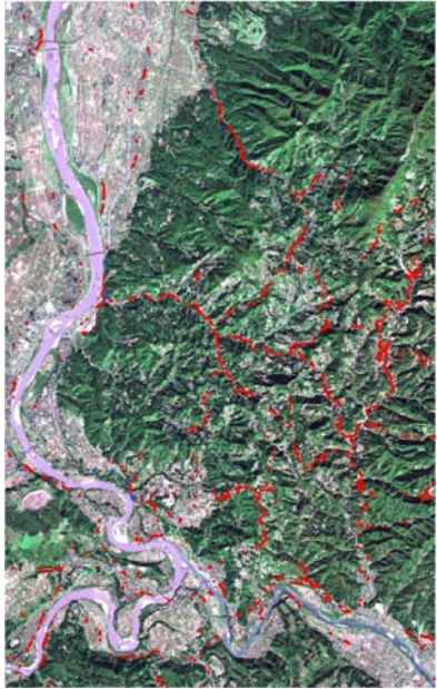
図 4 道路・鉄道推定被害域
