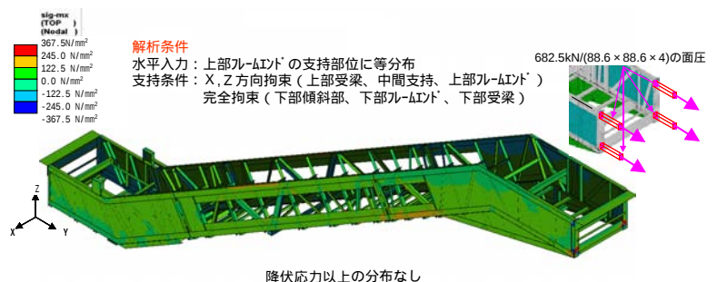
図-3 三次元 FEM 解析モデル及び応力コンター図
