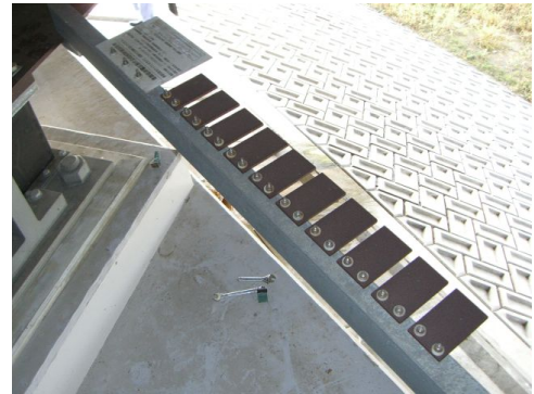
写真-2 曝露試験片の設置状況
