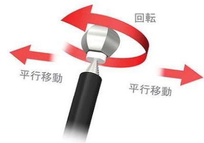
図-1 回転式打音検査器
