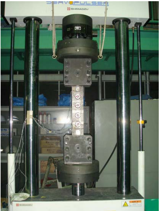
写真-2. 疲労試験状況
