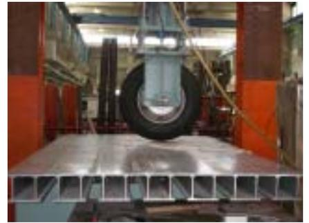
図-1 開閉断面のアルミニウム床版
