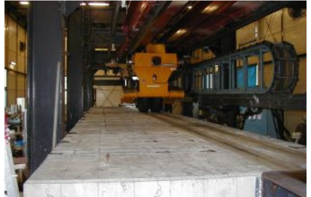
写真-1 張出し部の走行試験状況
