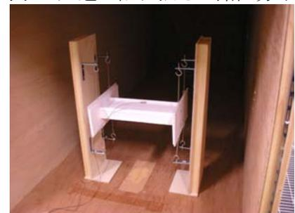
図3 弾性支持模型試験
