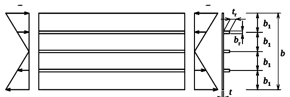
図-2 曲げを受けるストライプパネル
