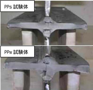
写真 1 ルート部から破断した試験体の一例
