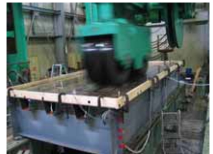
写真1 移動荷重疲労試験状況
