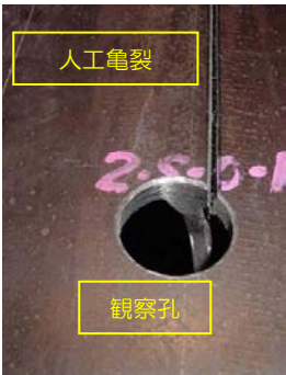
図2 人工き裂と観察孔
