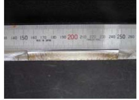
写真 2 破断面
