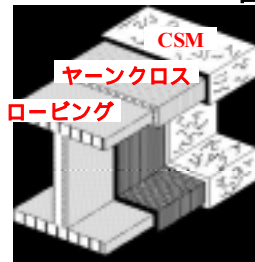
図-2 積層構成図
