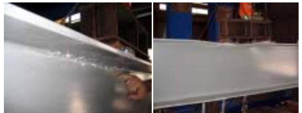
写真-4 Case A 破壊状況
