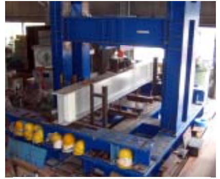
写真-3 曲げ試験 供試体設置図
