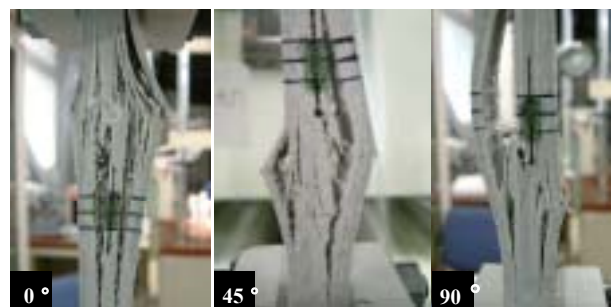
写真-2 圧縮破壊状況
