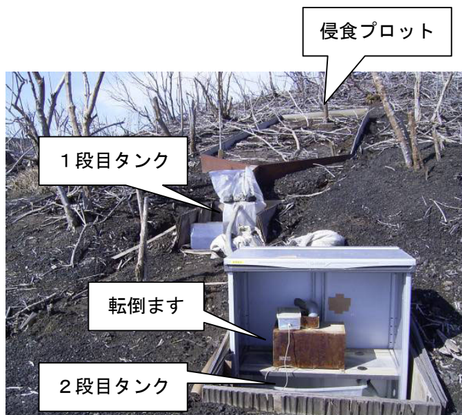
写真-1 流出土砂量測定試験装置
