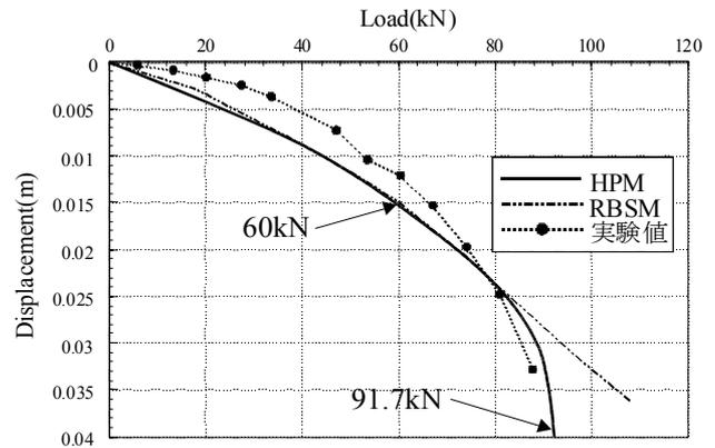
図3 荷重沈下曲線
