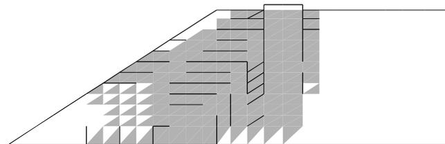
図5 破壊パターン (91.7kN 崩壊荷重)
