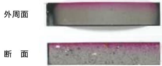
写真-1 試験体の着色状況(N-0.3, 上面が流入側)
