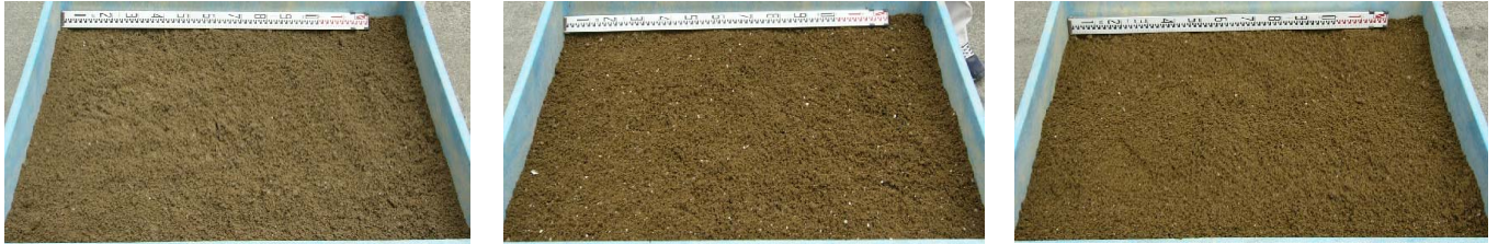
現地発生土A + クニゲル V1 (15%) 現地発生土A + クニゲル V1 原鉱石 (15%) 現地発生土A + ボルクレイ原鉱石 (15%)
