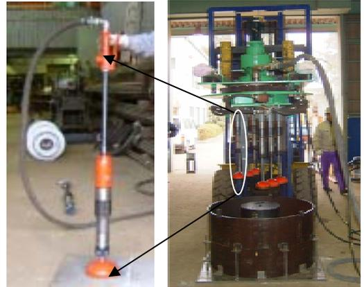
図1 小型ランマ 図2 型枠と締固め装置
