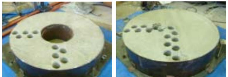
側部緩衝材を模擬し締固めた試験体 底部緩衝材を模擬し締固めた試験体
