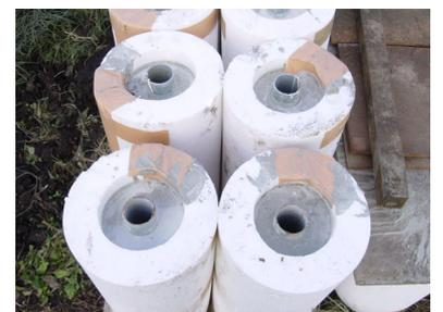
写真 - 2 充填材の形状
