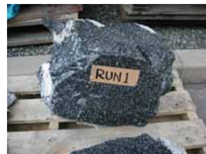
図 - 6 溶融後の固化体
