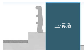
図5 下路橋の車両防護柵の例
