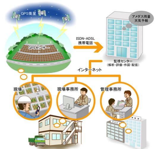
図-2 GPS 自動計測システム概念図
