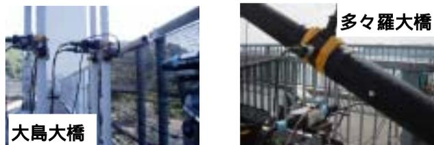
図-1 LDV と加速度計によるケーブル振動計測状況
