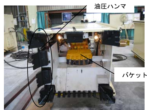
写真-3 レキ対応掘削機
