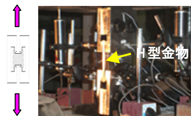
写真-1 鋼殻継手の引張実験
