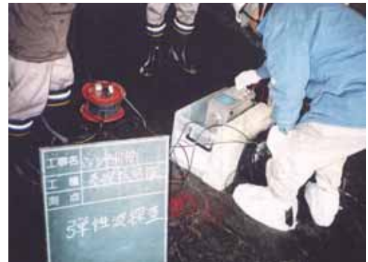
写真 - 1 電撃ハンマー衝撃弾性波法による測定状況
