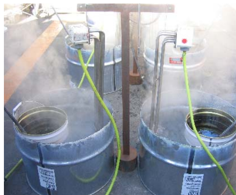
写真-1 ダンパーオイル加熱状況
