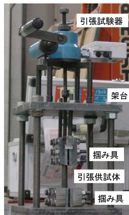
写真-1 引張試験装置
