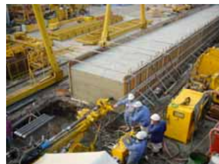
写真1 模擬土丹削孔実験状況
