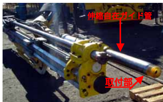
図-2 ガイド管先端部のウレタン性取付部
