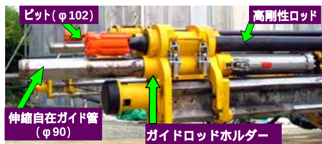
図-1 割岩装置：EG-Slitter
